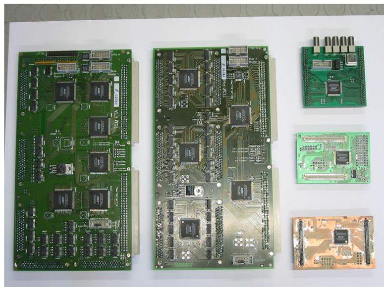
**Figura 6: circuiti sviluppati per il sistema di test JTAG delle motherboard PAD.**
