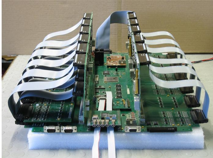
**Figura 7: sistema di test JTAG montato sulle motherboard PAD.**
