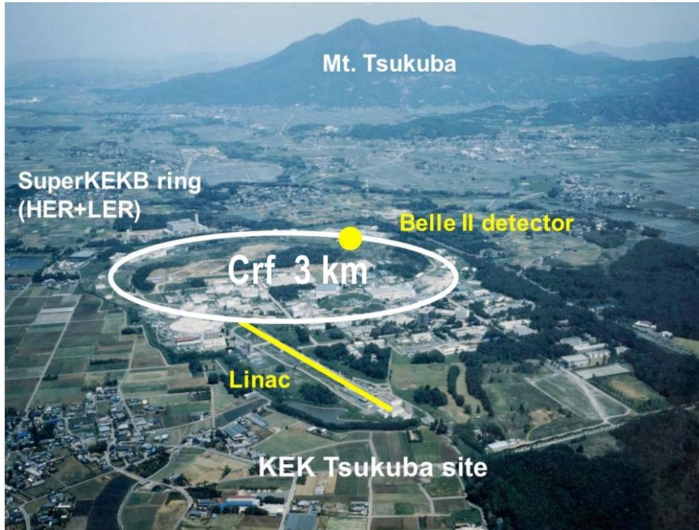
Il rivelatore Belle II si trova nel punto di collisione dell'acceleratore SuperKEKB.
